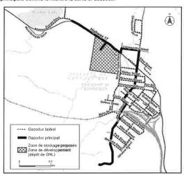
Collectivité de Terrace Bay; Construction d'un gazoduc principal de 5 kilomètres allongeant la Route Transcanadienne, la route Mill et une rue non identifiée, ainsi que d'une canalisation latérale de 13 kilomètres s'étendant à partir de la canalisation principale comme le montre la carte ci-dessous.
